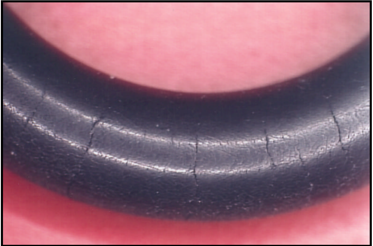
Bild 5: ein durch Ozoneinwirkung beschädigter O-Ring, leicht gedehnt
