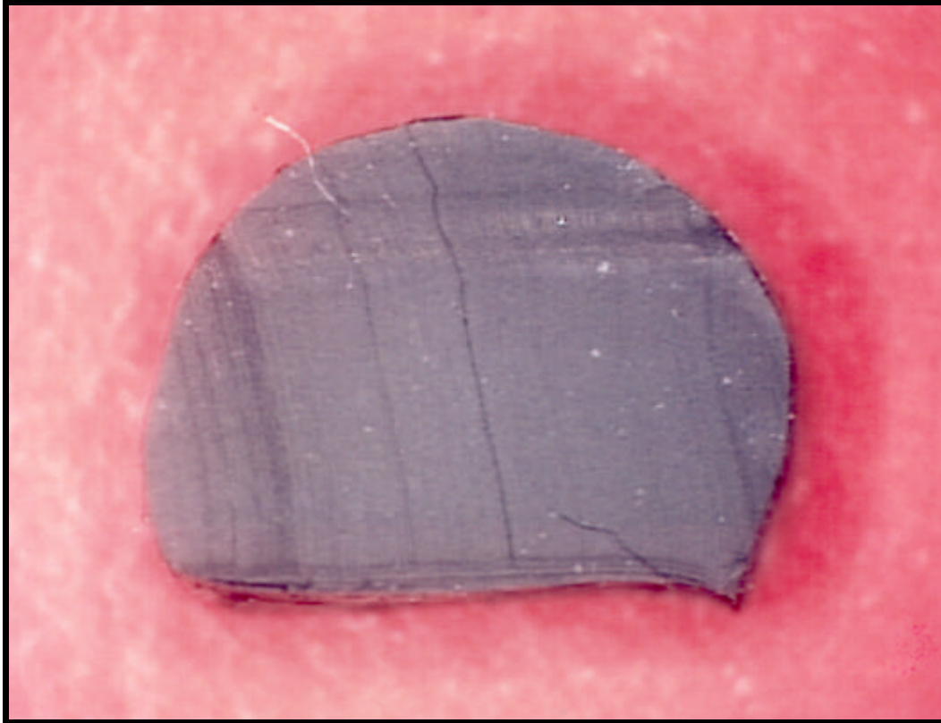
Bild 1: ein durch starke Quellung und anschließender dynamischer Beanspruchung ausgefallener O-Ring
